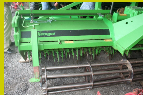
De aanaardfrees werd omgebouwd om vooraan op de traktor te kunnen werken.
