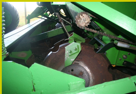
De grote gekartelde schijven halen de grovere aarde die de rug moet bedekken uit de diepte.
