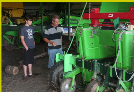
A. Ghyselen en zoon tonen de aardappelpootmachine die omgebouwd werd om planten en aanaarden in één werkgang te combineren.
