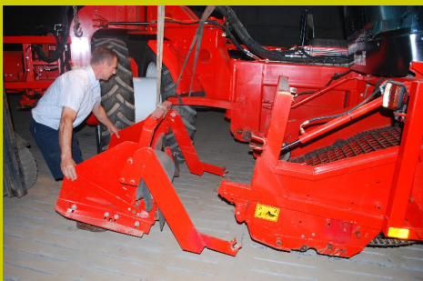
Om de rooi-units te wisselen is er amper enkele minuten nodig.
