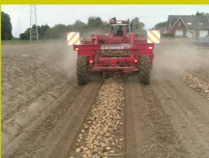
Pootaardappelen worden geogst met de Grimme RL3000. Die legt ze op rijen van 80cm breed.
