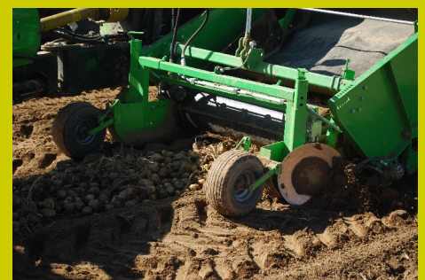
Een omgekeerd werkende aanaardschijf vrijwaart de aandrijving van de rollen van overmatig veel grond
