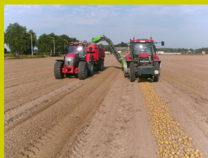
Na een tijdje drogen op het veld worden de pootaardappelen opgeraapt met een Esprit GTT van AVR
